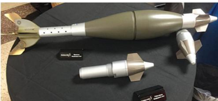
Kit de guiado ATK para proyectil de mortero 120 milímetros
